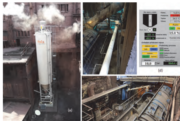
Obr. 1 Systém dávkování vápna do aglomerační směsi
