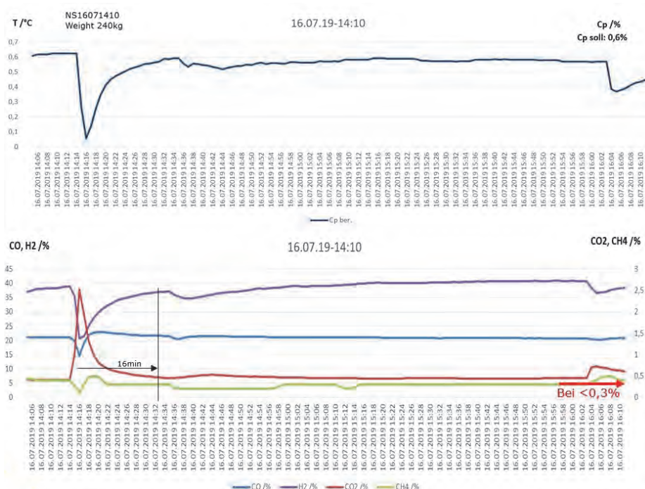
Obr. 5 Příklad vsázkové analýzy s inteligentní tryskou
