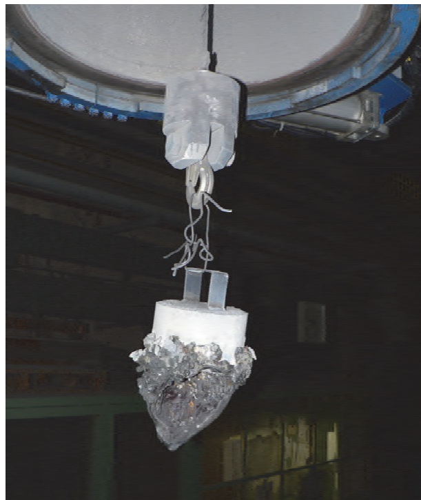
Obr. 3 Dávkovací přípravek s reakčním činidlem po dávkování do taveniny oceli v přetlaku argonu.
