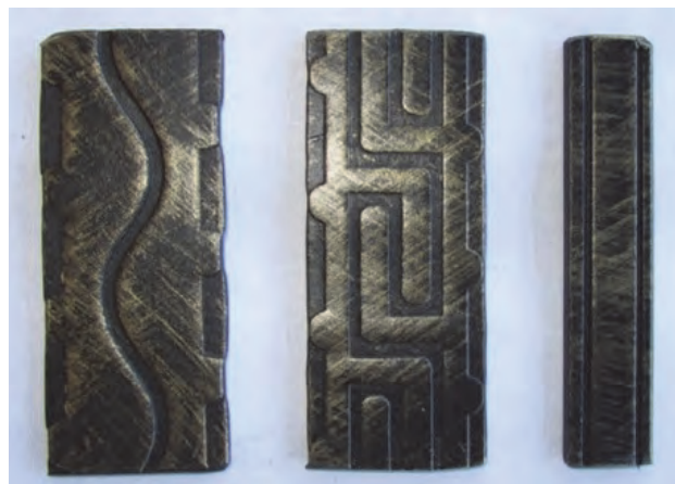
Obr. 36 Válcované pásy s reliéfem pro umělecké kováře
