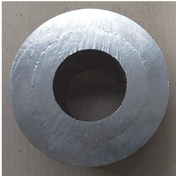
Obr. 3 Nespojené vrstvy u odlitku s výrazně překročenou prodlevou mezi odlitím první a druhé vrstvy
