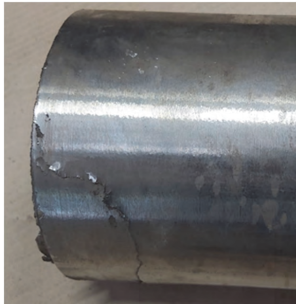
Obr. 4 Přelitá vrstva na konci odlitku
