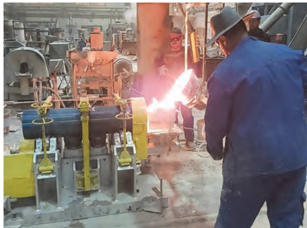
Obr. 1 Lití taveniny do horizontálního lícího stroje HOLS 300
