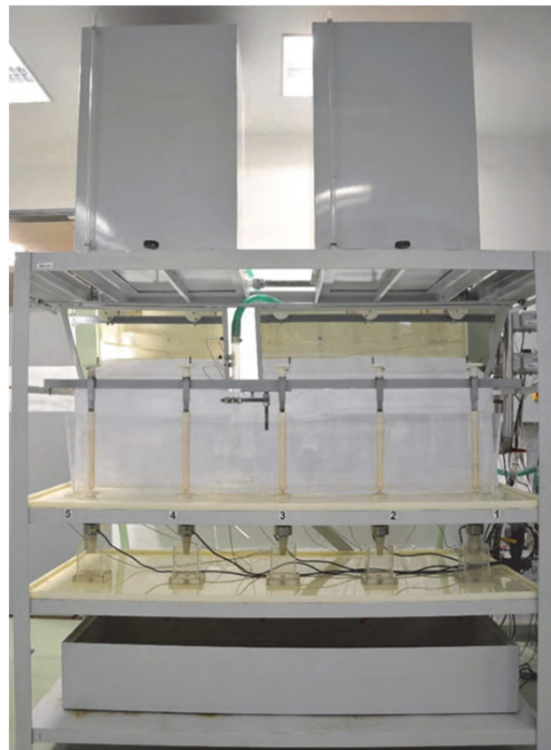
Obr. 1 Sestava fyzikálního modelu pětiproudé mezipánve s příslušenstvím
