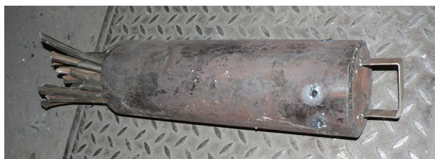
Obr. 2 Dávkovací přípravek s reakčním činidlem – plněný profil \text{CaFe} (97 hm. % Ca a 3 hm. % Fe)
