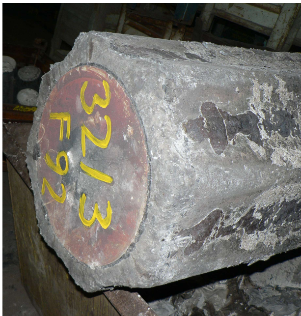
Obr. 5 Odlitý ingot se zalitou dopadovou deskou používanou při odlévání horem Fig. 5 Ingot with impact plate encased due to the use of top pouring technology
