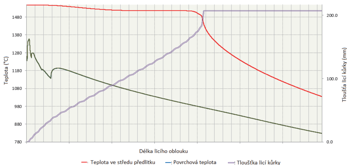
Obr. 1 Výstup modelu - teplotní profil a tloušťka licí kůrky podél licího oblouku Fig. 1 Model output – temperature distribution and shell thickness along a strand
