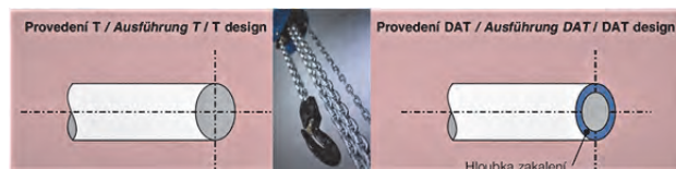
Obr. 2 Rozdíl v provedení T a DAT u řetězů pro řetězová zdvihadla [17]
