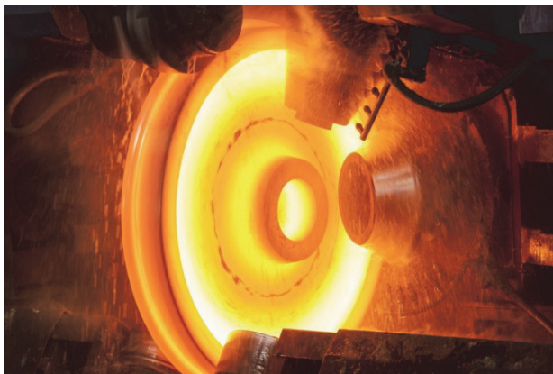
Obr. 7 Pohled na rozkovek v devítiválcové válcovačce
