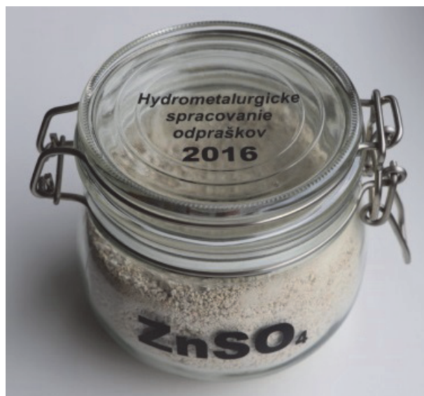
Obr. 2 Výsledné produkty pilotnej poloprevádzkovej linky LSPO: oxid zinočnatý (hore), síran zinočnatý (dole)
