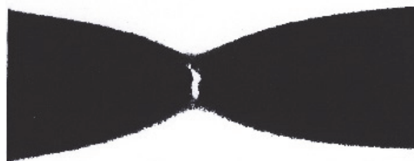
Obr. 5 RTG snímek příčné makrotrhliny při skutečné deformaci \delta_K = 1,06 před úplným přetržením vzorku v podmínkách podle obr. 3
