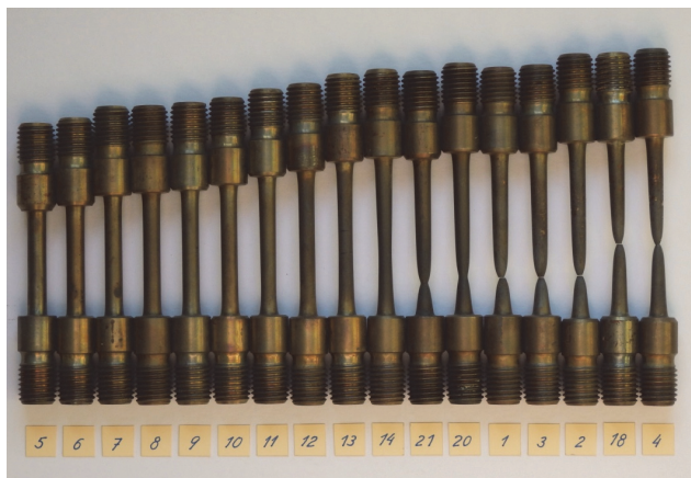
Obr. 1 Tahové vzorky z oceli Cr18Ni10Mo2 seřazené podle velikosti deformace až do mezního stavu; teplota 800 °C, počáteční rychlost deformace 2 \cdot 10^{-3} \text{ s}^{-1}
