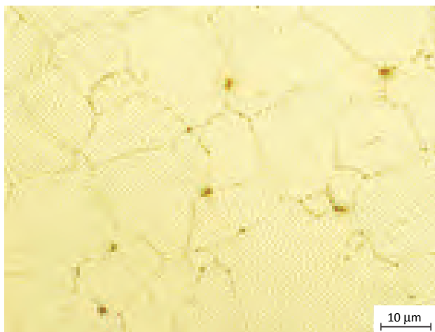
Obr. 7 Mikrostruktura deformovaných kroužků z oceli Super 304H po expozici, vlevo bez žhání po ohýbání, vpravo vzorky vyžháné
