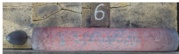
Obr. 8 Vzorek po ideálně povedeném děrování s nepoškozeným děrovacím trnem; nastavení úhlů \alpha = 4^\circ , \beta = -1,5^\circ , úběr 5,5 mm, deformace 45 %, průměrné rozšíření 9 %
