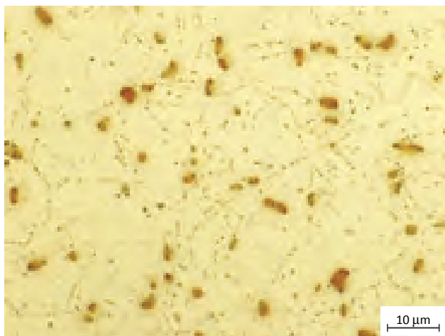
Obr. 7 Mikrostruktura deformovaných kroužků z oceli Super 304H po expozici, vlevo bez žhání po ohýbání, vpravo vzorky vyžháné
