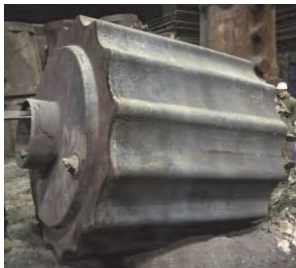
Obr. 20 Úspěšně odlitý dutý ingot Fig. 20 The successful cast hollow ingot
