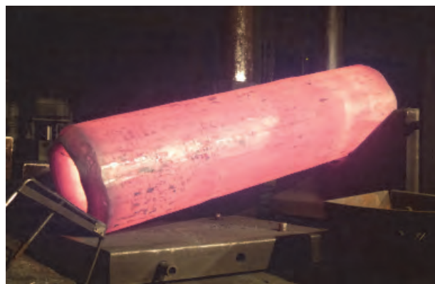
Obr. 21 Výkovek z dutého ingotu Fig. 21 The forging made from hollow ingot
