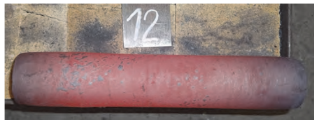
Obr. 9 Vzorek vyděrovaný s největším rozšířením cca 14 % a nejmenší deformací; nastavení úhlů \alpha = 4^\circ , \beta = -2^\circ , úběr 3,5 mm (malý), deformace okolo 36 %, průměrné rozšíření 13 %
