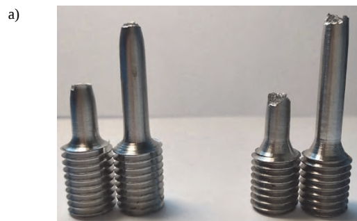
Obr. 4 Makroskopický pohled na přetržené vzorky po tahové zkoušce: a) vzhled lomových ploch (vlevo – kovaný a vpravo – SLM); tvorba krčku u vzorků b) kovaných ( \epsilon_f = 13,6 \% ) a c) SLM ( \epsilon_f = 7,2 \% )
