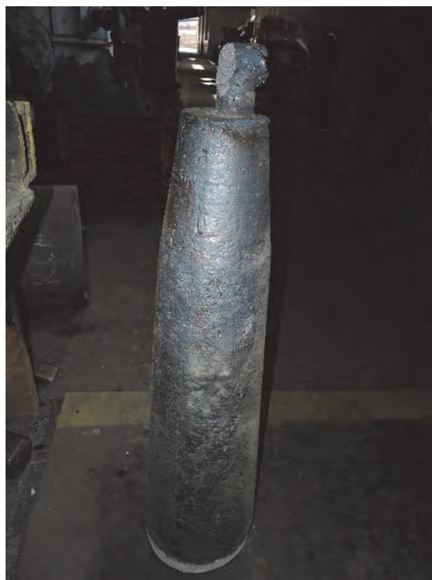
Obr. 5 Odlitý ingot z oceli s 0,12 % Bi Fig. 5 Ingot část from steel with 0.12 % Bi
