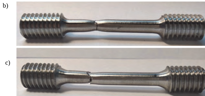
Obr. 4 Makroskopický pohled na přetržené vzorky po tahové zkoušce: a) vzhled lomových ploch (vlevo – kovaný a vpravo – SLM); tvorba krčku u vzorků b) kovaných ( \epsilon_f = 13,6 \% ) a c) SLM ( \epsilon_f = 7,2 \% )
