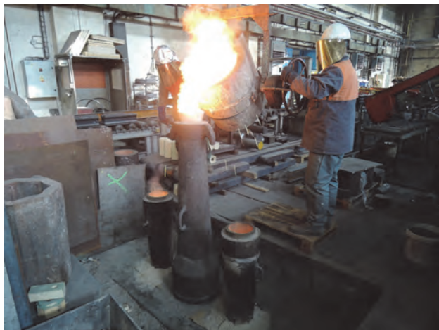
Obr. 4 Odlévání taveniny oceli z licí pánve, spodem do předem připravených kokil Fig. 4 Bottom casting of molten steel from pouring ladle into the prepared ingot moulds
