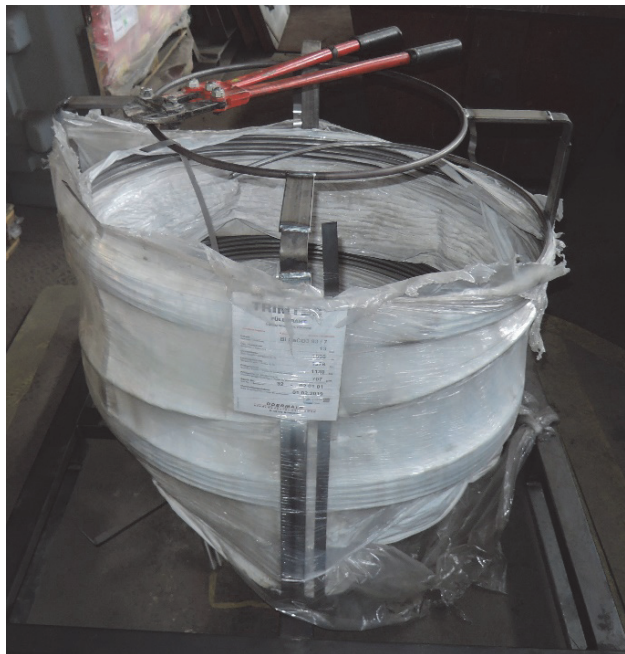
Obr. 1 Plněný profil legující přísady Bi/CaCO 3 Fig. 1 Xored wire containing the alloy Bi/CaCO 3
