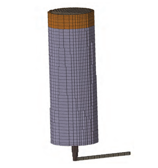
Obr. 5 Výpočetní síť modelované geometrie kruhového těžkého kovářského ingotu
