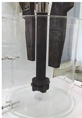
Obr. 1 Fyzikální model zařízení pro rafinaci hliníku [11]
