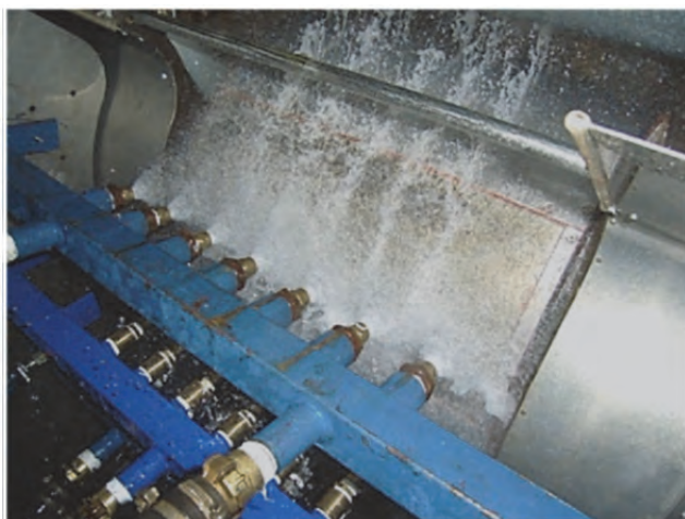
Obr. 1 Experimentální válec pro určení součinitele přestupu tepla
