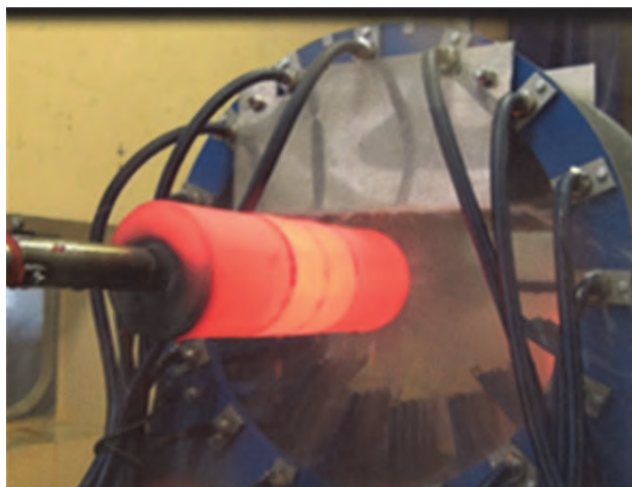
Obr. 7 Optimalizace chlazení trubek (vlevo), optimalizace chlazení kolejnic (vpravo) Fig. 7 Optimization of tube cooling (left), optimization of rail cooling (right)
