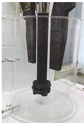
Obr. 1 Fyzikální model zařízení pro rafinaci hliníku [11]
