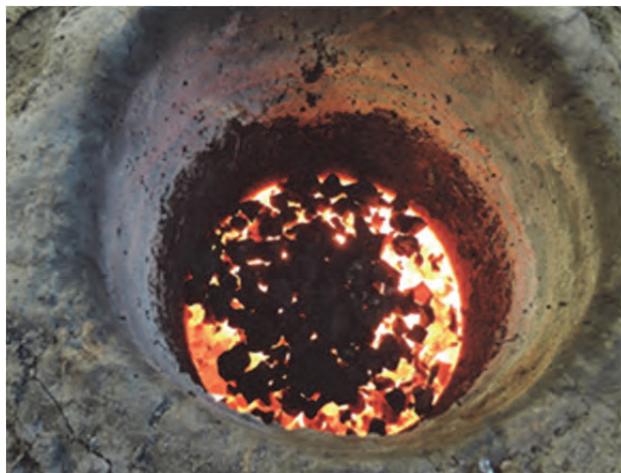
Obr. 6 Struska na hladině taveniny bezprostředně po nasazení poslední dávky ze 45 kg
