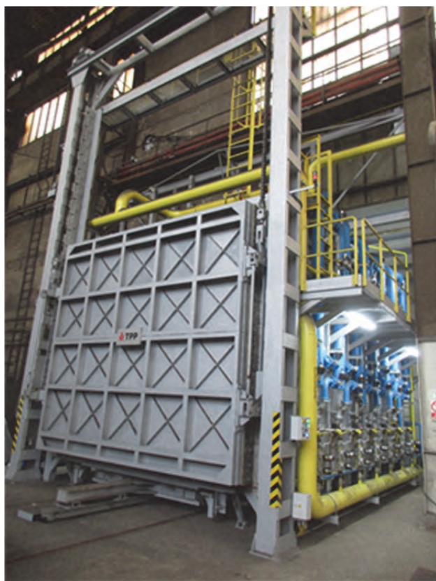
Obr. 6 Žíhací pec – zapnutá Fig. 6 Annealing furnace – switched on
