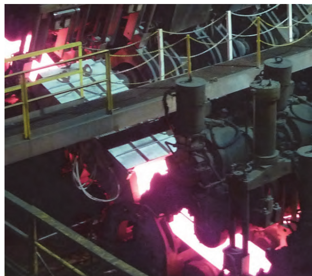
Obr. 2 Aktivní dohřevová komora před tažně-rovnací stolicí
