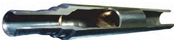
Obr. 12 Náprava vykováná radiálním kováním s použitím trnu [6]
