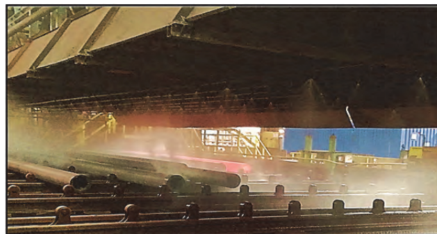
Obr. 1 Řízené ochlazování bezešvých trubek na trati Velký Mannesmann
