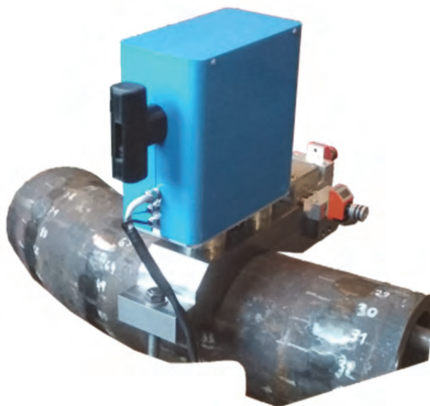
Obr. 21 Aplikace tvrdoměru MABIT v provozních podmínkách
