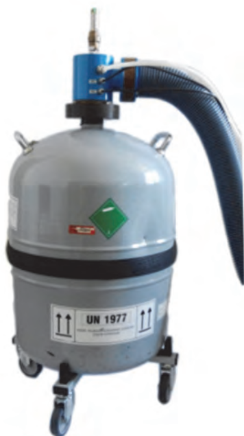
Obr. 12 Dewarova nádoba s tekutým dusíkem a dávkovací sondou
