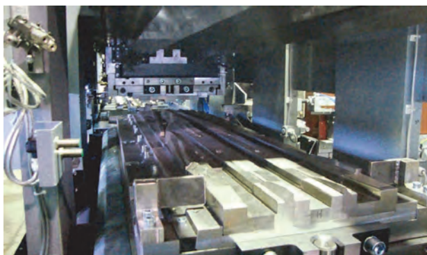
Obr. 7 Pohled do pracovního prostoru válcovačky pro příčné klínové válcování železničních náprav [1]
