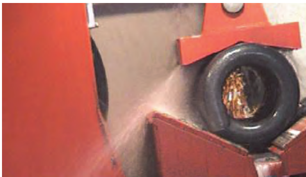
Obr. 2 Způsob upnutí pružiny pro broušení Fig. 2 Method of gripping the spring for grinding
