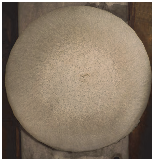
Obr. 4 Příčný makrolept předlitku ø 600 mm s použitím EMS
