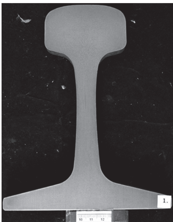
Obr. 1 Středová segregace ve stojině kolejnic Fig. 1 Central segregation in rail webs
