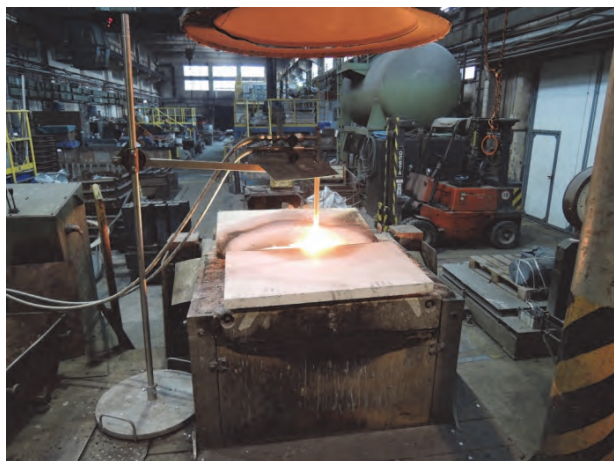
Obr. 3 Atmosférická indukční tavící pec s kyslíko-palivovým hořákem v průběhu experimentální tavby se zakrytým kelímkem pomocí sibalových desek
