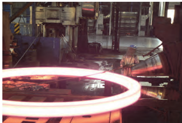
Obr. 6 Rozválcování kroužku ve firmě Bohemia Rings, s.r.o., Zámorsk
