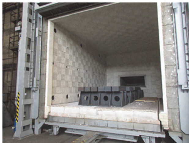
Obr. 7 Žíhací pec se vsázkou Fig. 7 Annealing furnace with batch
