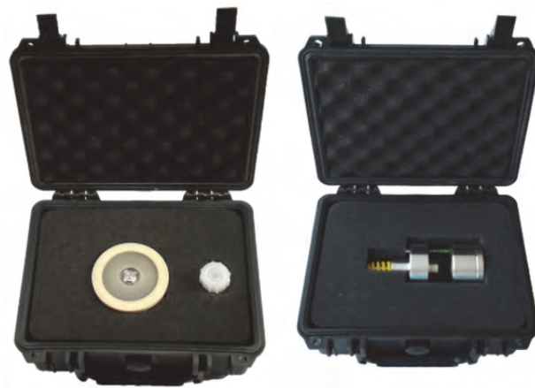
Obr. 11 Přípravek pro broušení (vlevo) a pro vystřížení SPT vzorku (vpravo)
