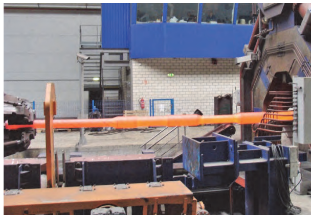
Obr. 2 Kování železniční nápravy na radiálním kovacím stroji jako vícenásobný výkovek
