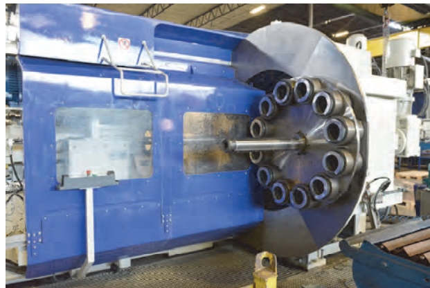
Obr. 3 Nová dvojitá bruska čel šroubových pružin Fig. 3 New double grinder for helical spring fronts
