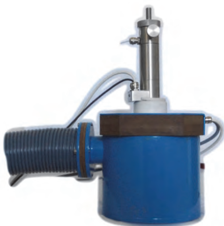
Obr. 13 Kryogenní komora se zkušební trnem
