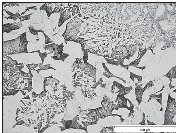
c) DCCT ( T_A = 1280\text{ °C} ) vzorek ochlazovaný rychlostí 0,5\text{ °C}\cdot\text{s}^{-1} c) DCCT ( T_A = 1280\text{ °C} ) sample cooled by cooling rate of 0.5\text{ °C}\cdot\text{s}^{-1}
