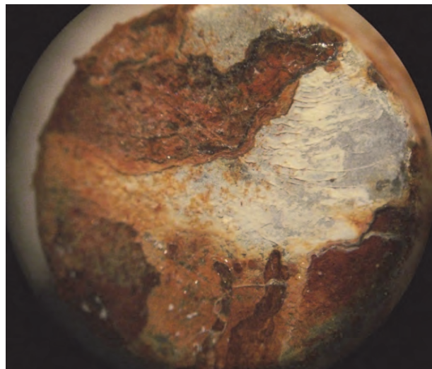
Obr. 9 Vzorek s povlakem Zn (zbytky) po expozici v solné mlze 56 hodin; rezavění magnetu NdRE-Fe-B
