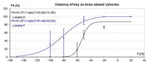
Obr. 4 Vidalovy křivky ze spodní (D) a horní (P) části výkovku [8]
