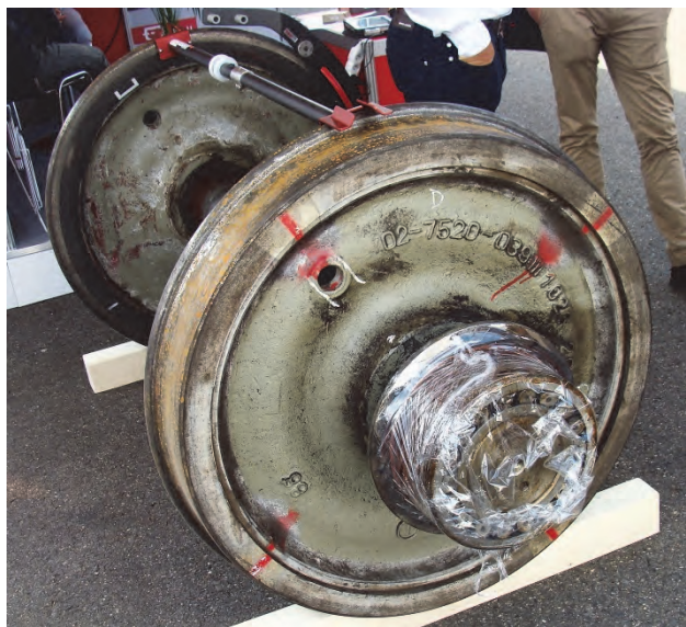
Obr. 19 Dvojkolí vymontované z lokomotivy; kola mají ploché disky z lité oceli
