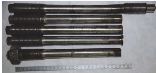
Fig. 3 Fractured and bent stud bolts Obr. 3 Zlomené a deformované svorníky
