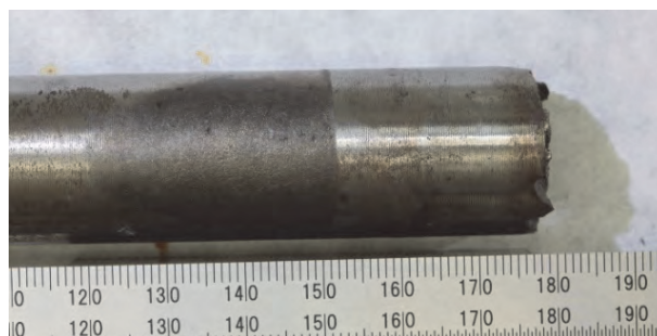
Fig. 4 Investigated stud bolts - an area of the fracture Obr. 4 Analyzovaný svorník – oblast lomu
