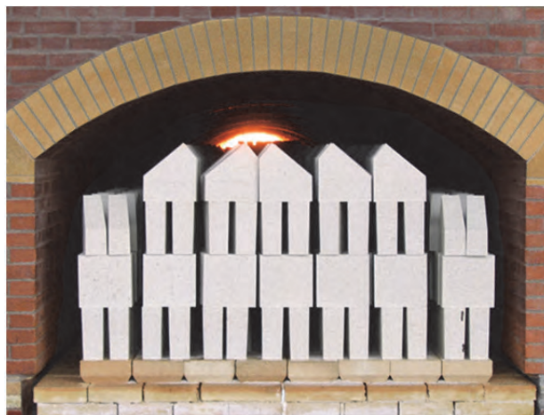
Obr. 5 Šamotové tvarovky připravené na výpal v tunelové peci
