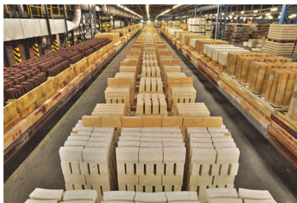
Obr. 6 Vypálené šamotové a magnetitové tvarovky připravené k vykládce a třídění, současný stav
