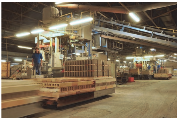
Obr. 3 Lisování tvarovek na lisu Sacmi, současný stav
