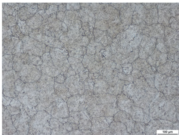
Obr. 8 Tavba 1 – výkovek / Příčný směr, Vilella Bain
