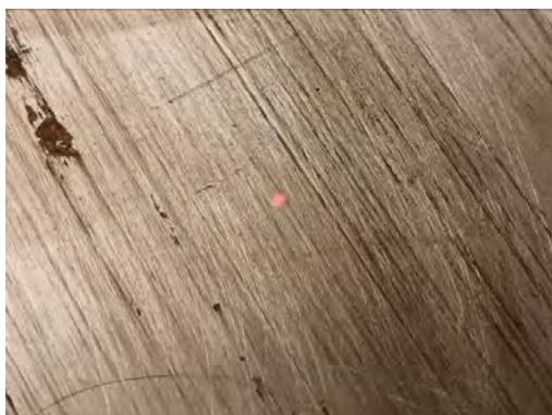
Obr. 7 Bod laserového snímače na povrchu zkušební vzorku Fig. 7 Dot of the laser sensor on tested blank's surface
