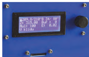
Obr. 5 Ovládanie tlačiarne cez koliesko s LCD displejom
