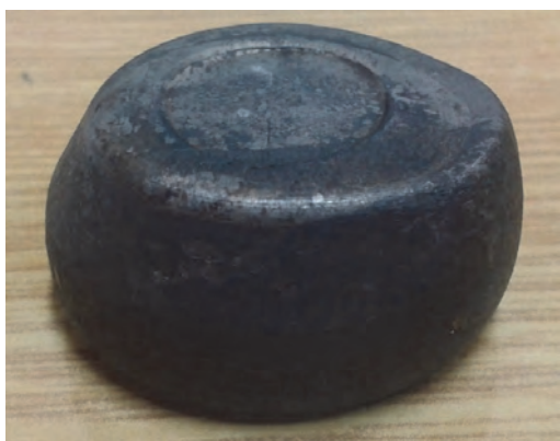
Obr. 7 Srovnání tvaru výkovku po 1. operaci v simulaci a ve skutečnosti. Fig. 7 Comparison of the shape of forging after the 1 st operation in simulation and in reality
