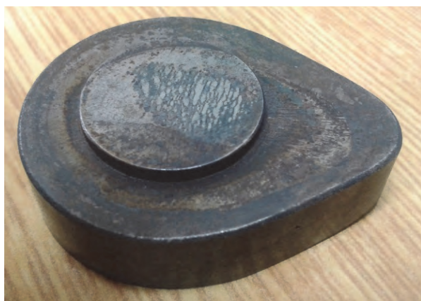
Obr. 9 Paprskovité povrchové útvary odpovídají oblasti s maximální hodnotou lomového kritéria Fig. 9 The radial surface formations correspond to the area with the maximum values of the fracture criterion.
