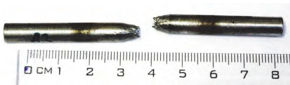
Obr. 1 Přetržená tyč z oceli A Fig. 1 The ruptured bar from the steel A
