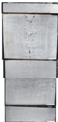
Obr. 1 Makrostrukturní rozbor ingotu typu V2A, značky 14209Mo Fig. 1 Analysis of macrostructure of the Ingot Type V2A, grade 14209Mo
