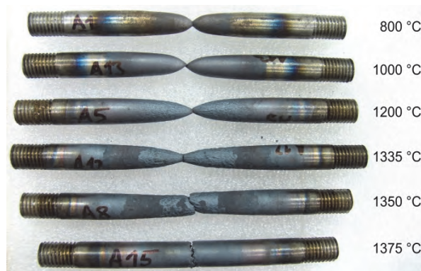
a) tvar zkušebních vzorků po přetržení a) shape of the tested samples after rupture
