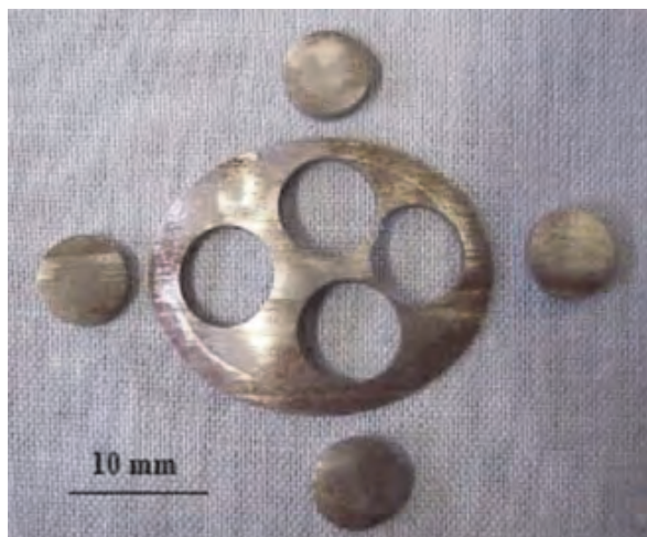
Obr. 5 Zkušební tělesa pro penetrační test prostřížena z odebraného experimentálního materiálu
