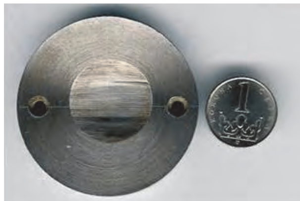
Obr. 3 Místo po odběru vzorku odběrovým zařízením SSamTM-2
