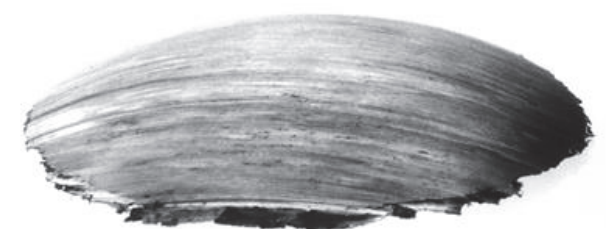
Obr. 4 Experimentální materiál odebraný pomocí odběrového zařízení SSamTM-2
