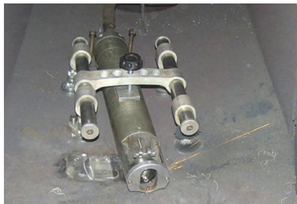
Obr. 2 Odběrové zařízení SSamTM-2 upnuté na posuzovaném zařízení
