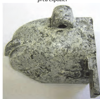
Obr. 7 Výsledky korozních zkoušek v neutrální solné mlze povrchově neupravené slitiny AlSi11Cu3Fe Fig. 7 NSS corrosion test results of surface unmodified AlSi11Cu3Fe alloy before and after 24 h exposure
