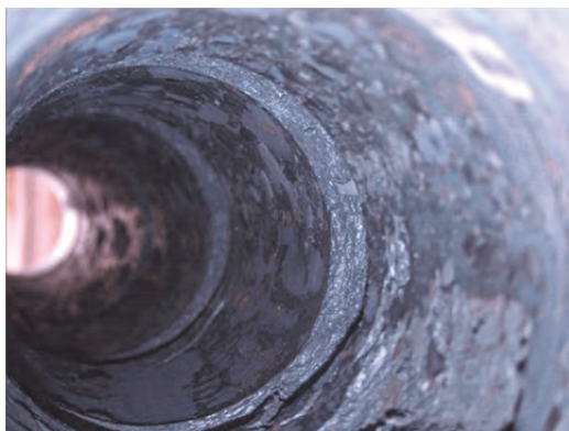
Obr. 1 Devastující účinek cyklické grupy Z4 na výděrek z předvrtané vsázky z oceli 42CrMo4
