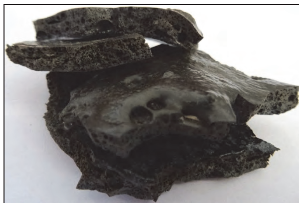
Obr. 1 Vzhled strusky při příjezdu na LF – 1. zkouška
