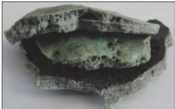
Obr. 2 Vzhled strusky před výdrží na LF – 2. zkouška Fig. 2 Appearance of the slag before thermal endurance in the LF – 2 nd test
