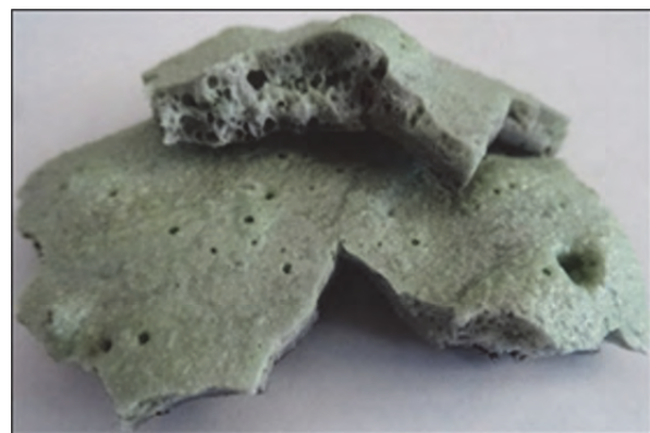
Obr. 4 Struska na LF – 4. zkouška – po přidání chladicího šrotu a po dolegování, dezaktivaci strusky drceným Al a po přidání vápna u oceli
