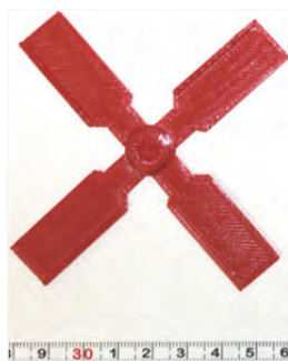
Obr. 7 Vrtuľa modelu veterného mlyna z ABS Fig. 7 Propeller of the watermill model from ABS
