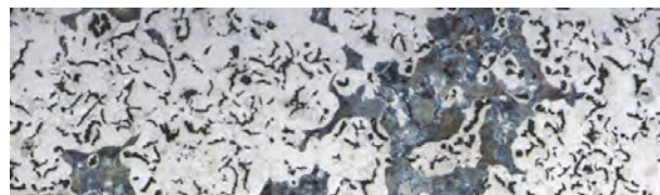
Obr. 3 Mikroštruktúra liatiny s červíkovitým grafitom, zv. 100× Fig. 3 Cast iron with vermicular graphite, zoomed, 100×
