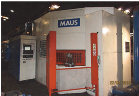
Obr. 10 Broušící stroj MAUS typ SAM 300 Fig. 10 Grinding machine MAUS type SAM 300
