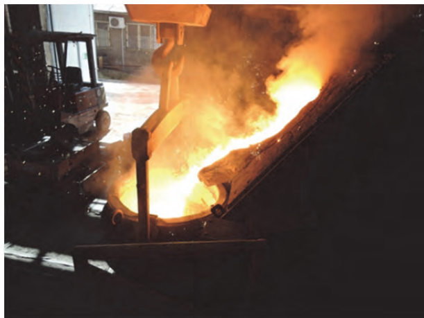
Obr. 7 Odlévání taveniny z atmosférické indukční tavicí pece do lící pánve
