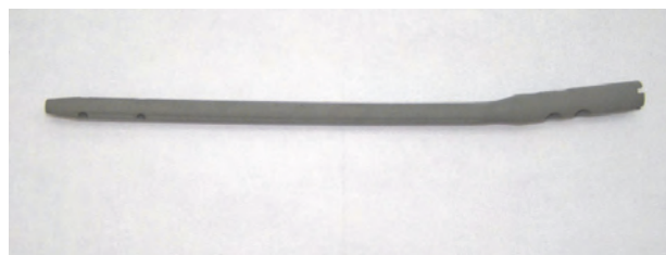
Obr. 5 Anodizovaný rekonstrukční hřeb procesem MAO Fig. 5 Reconstruction nail anodized by MAO process
