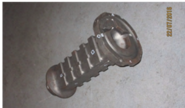
Obr. 12 Odlitek připravený k proměření 3D skenerem Fig. 12 Casting prepared for measuring by 3D scanner
