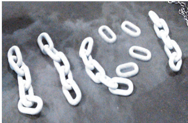
Obr. 1 Vzorky řetězu 30x108 vytažené z tekutého dusíku Fig. 1 Samples of chain 30x108 extracted from liquid nitrogen
