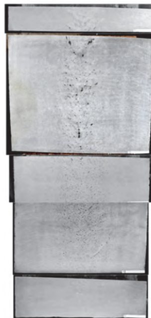
Obr. 10 Makrostruktura v ose ingotu
