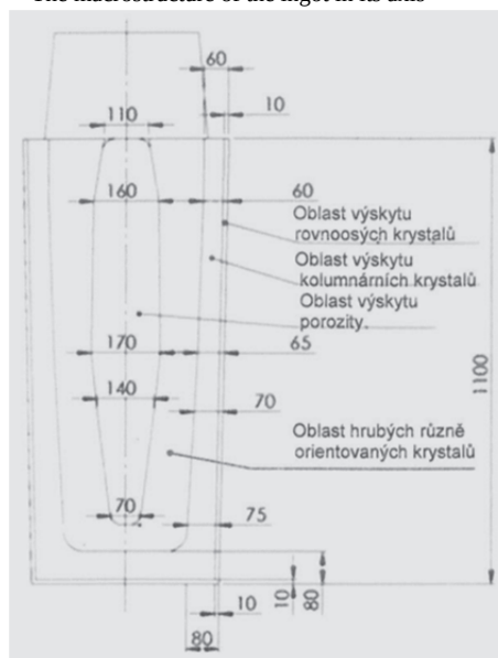
Obr. 11 Schématická analýza makrostruktury v ose ingotu
