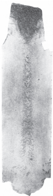
Obr. 5 Mezerové vycezeniny typu V na Baumannově otisku podélného řezu ingotem
