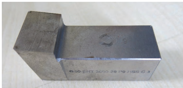
Obr. 7 Obrážecí nůž Fig. 7 Slotting knife
