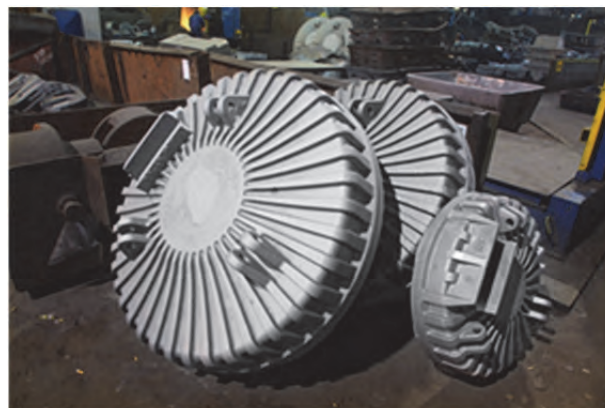
Obr. 14 Ocelové odlitky magnetů připravené k expedici Fig. 14 Steel magnet castings ready for expedition
