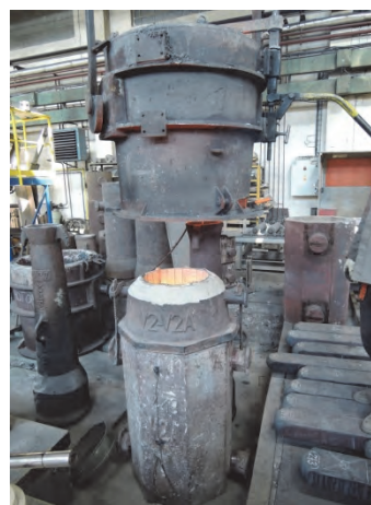
Obr. 8 Odlévání taveniny z lící pánve spodem do kokilové sestavy V2A
