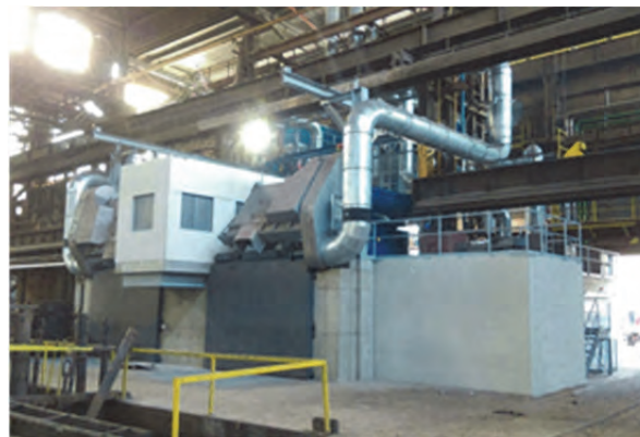
Obr. 8 Středofrekvenční EIP 2 \times 15 t Fig. 8 Medium frequency EIF 2 \times 15 t
