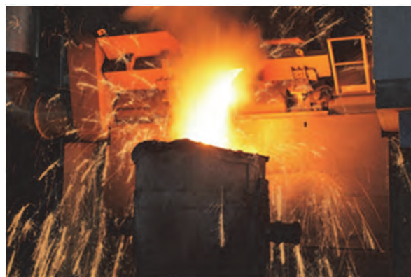
Obr. 9 Odpich ze středofrekvenční EIP Fig. 9 Tapping of medium frequency EIF
