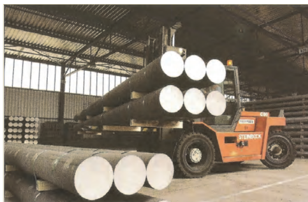
Obr. 5 Čapy z Al zliatin pre prietlačné lisovanie, jedny z produktov spoločnosti SIVALCO a.s., Žiar nad Hronom, 2005
