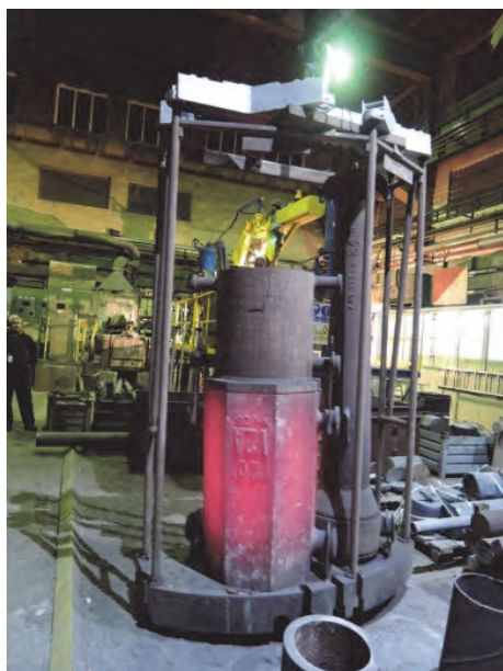
Obr. 19 Kokilová sestava z 1. experimentu, hodinu po odlití, vytažená z kesonu VPIM
