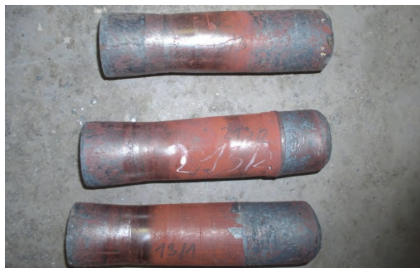
Obr. 5 Nedovalky 213-1, 2 a 3 z oceli 42CrMo4 (vpravo přední konec)
