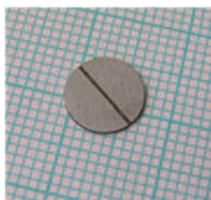
Obr. 2 Zkušební těleso tvaru disku s „U“ vrubem v ose roviny disku [1, 5]
