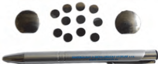
Obr. 1 Zkušební vzorky pro penetrační testy (small samples) Fig. 1 Small test samples for penetration tests
