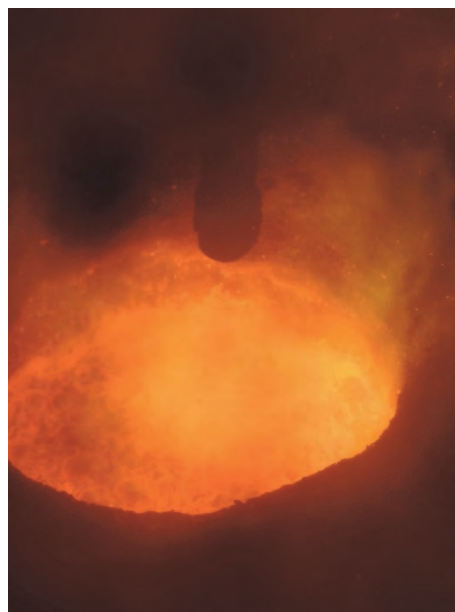
Obr. 21 Proces VOD při tlaku 10 kPa, u 6. experimentální tavby
