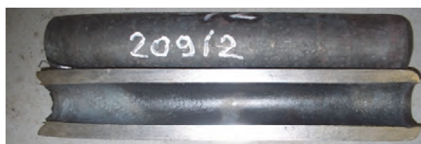
Obr. 6 Vnější a vnitřní povrch zkoušky 209-2 (vlevo přední konec)
