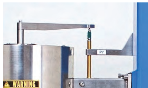
Obr. 3 Měření posunu razníku Fig. 3 Measurement of the punch movement
