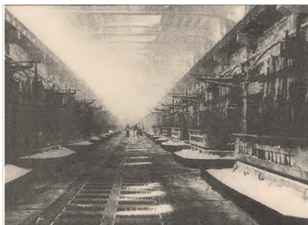
Obr. 3 Celkový pohľad do B série elektrolyzy, v ktorej boli elektrolyzéry usporiadané v dvoch radoch, Žiar nad Hronom, 1955
