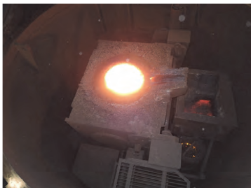
Obr. 20 Odlitá kokilová sestava s mezipánví v kesonu VPIM u 2. tavby
