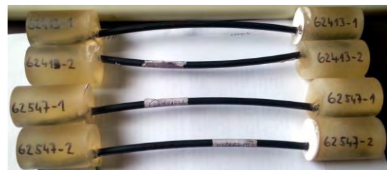
Obr. 3 Uchycení drátů v dentakrylových pouzdech Fig. 3 Special gripping of specimens
