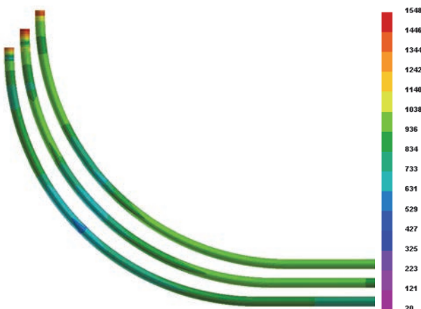
Fig. 3 Billets temperature field (from the left to right A, B, C) Obr. 3 Teplotní pole předlitků (zleva doprava A, B, C)
