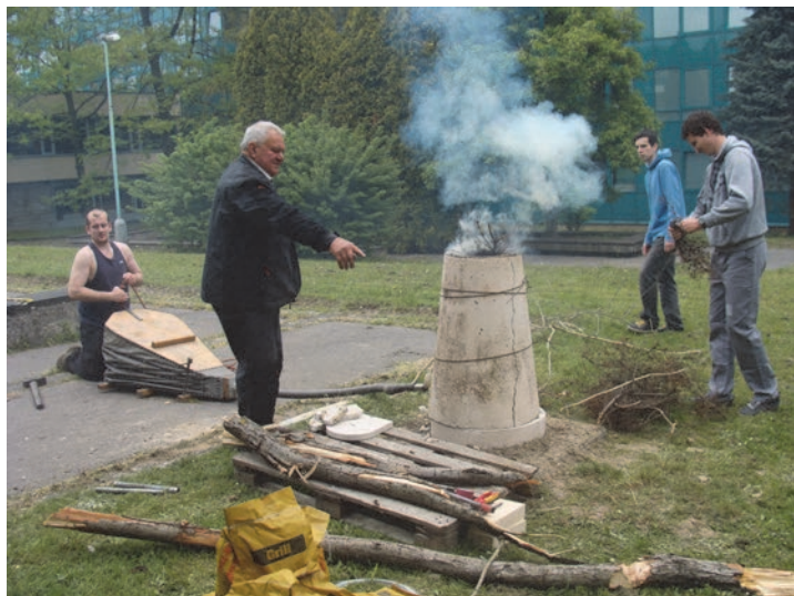
Obr. 2 Novodobý pokus redukce železné rudy dřevěným uhlím, VŠB – TU Ostrava, 2016
