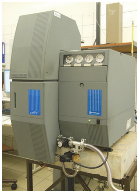
Fig. 1 Setaram SETSYS 18 TM device used for TMA measurements Obr. 1 Přístroj Setaram SETSYS 18 TM použitý pro TMA měření
