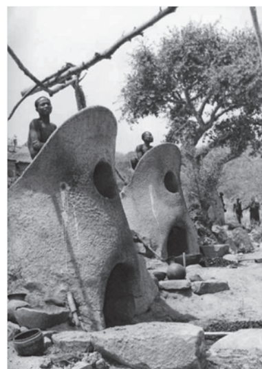
Obr. 7 Pece používané k výrobě železa v subsaharské Africe do poloviny 20. století
