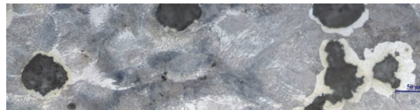
Obr. 2 Mikroštruktúra liatiny s guľôčkovým grafitom, zv. 200× Fig. 2 Microstructure of cast iron with nodular graphite, zoomed 200×
