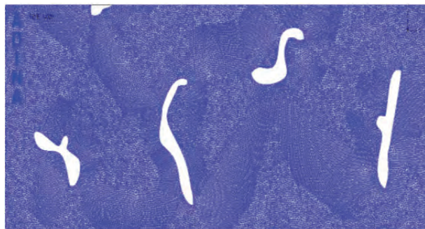
Obr. 5 Detail konečnoprvkovej siete pre štruktúru s dutinami vermikulárneho tvaru
