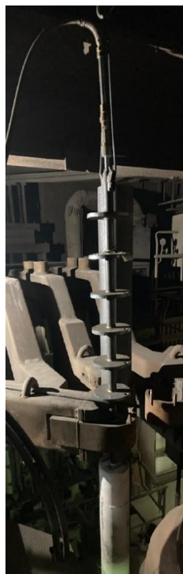
Obr. 2 Instalace kyslíkové ponorné trysky na LF
