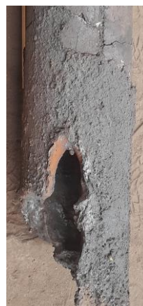
Obr. 6 Opotřebení ústí trysky Fig. 6 Wear on the lance output
