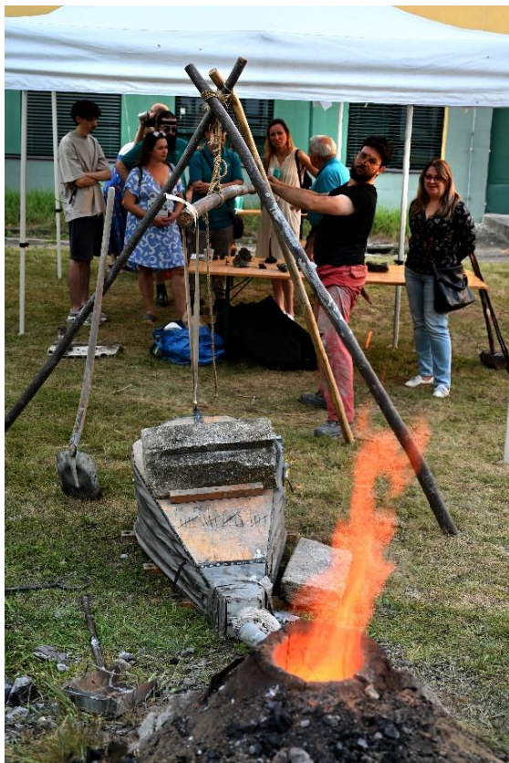
Ukázka výroby železné houby v laténské šachtové peci
