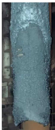
Obr. 5 Stav trysky po použití Fig. 5 Condition of the lance after use
