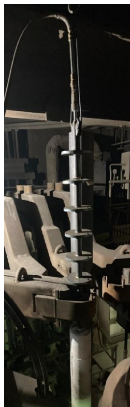
Obr. 2 Instalace kyslíkové ponorné trysky na LF
