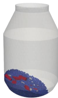
Fig. 3 Non-uniform scrap distribution inside the converter after simple rocking Obr. 3 Nerovnoměrné rozložení šrotu uvnitř konvertoru po jednoduchém naklonění
