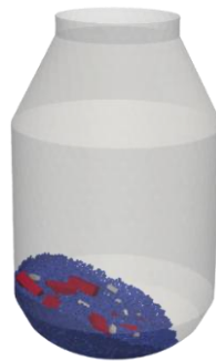
Fig. 3 Non-uniform scrap distribution inside the converter after simple rocking Obr. 3 Nerovnoměrné rozložení šrotu uvnitř konvertoru po jednoduchém naklonění
