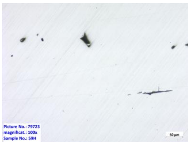
Obr. 2 Mikročistota oceli standardně odlévané tavby jakosti GS25CrNiMo4
