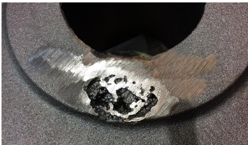
Fig. 5 Detail of internal shrinkage on the casting under examination Obr. 5 Detail vnitřního smrštění na zkoumaném odlitku
