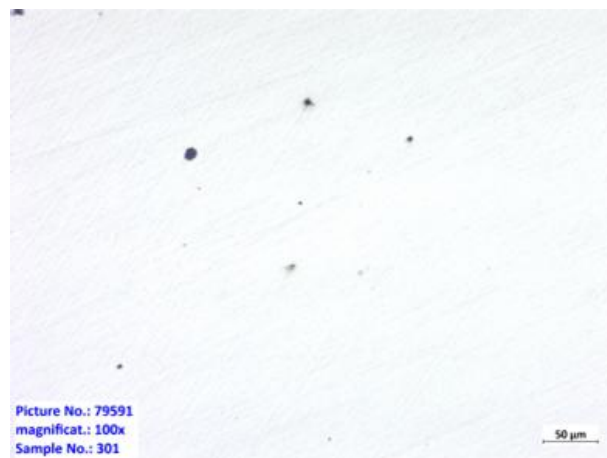
Obr. 3 Mikročistota oceli přelévané tavby jakosti GS25CrNiMo4
