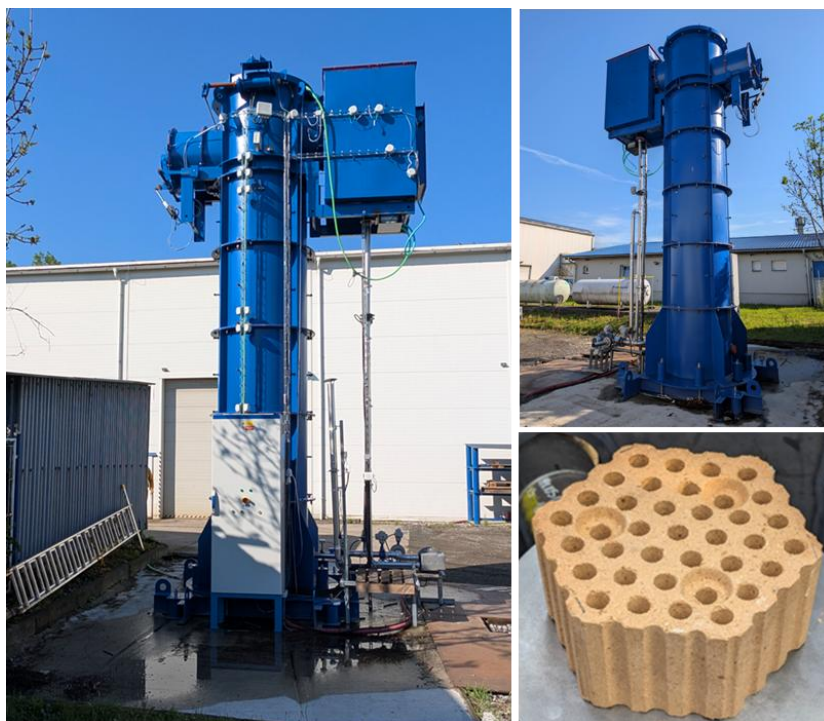
Obr. 1 Experimentální vysokoteplotní akumulací jednotka a keramická akumulací tvarovka Fig. 1 Experimental High-Temperature Heat Storage Unit and Ceramic Heat Storage Fitting
