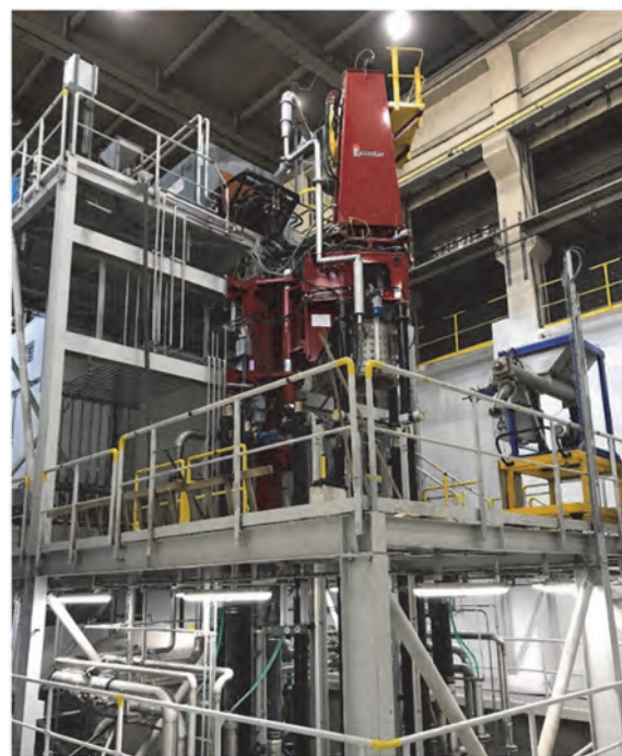
Obr. 2 Zařízení ESR (CONARC) ve ŽĐAS, a.s. Fig. 2 ESR equipment (CONARC) in ŽĐAS, a.s.
