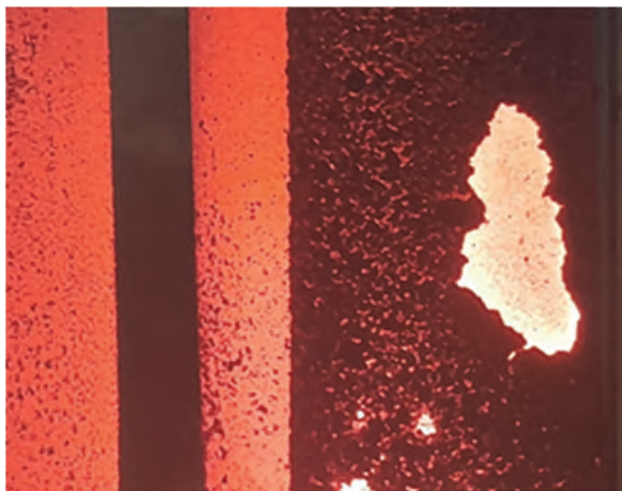
Obr. 7 Vada GE 5A – lokální ztráta vrstvy alitace v místě původního poškození
