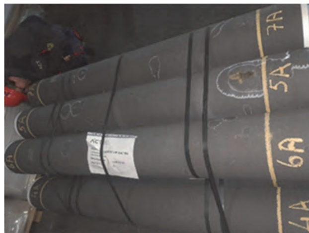
Obr. 2 Zkušební alitované elektrody Fig. 2 Aliteted electrodes for test
