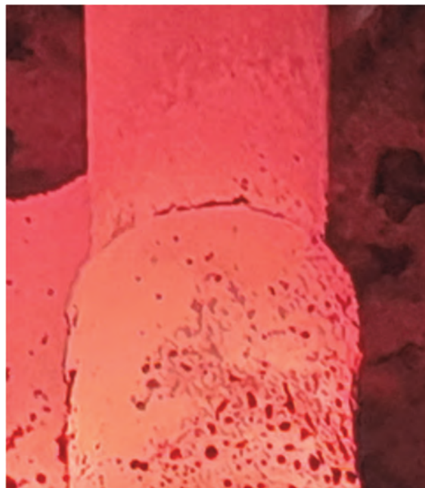
Obr. 6 Přechod standardní (horní)/ alitovaná (dolní) Fig. 6 Transition from standard GE (upper) to alited GE (lower)
