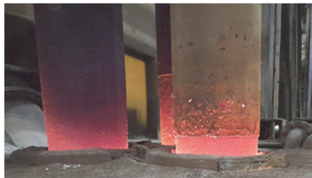
Obr. 5 GE vpravo – přechod alitovaná (horní)/standardní (dolní) Fig. 5 Right: Transition from alited GE (upper) to standard GE (lower)
