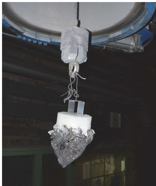
Obr. 3 Dávkovací přípravek s reakčním činidlem po dávkování do taveniny oceli v přetlaku argonu.
