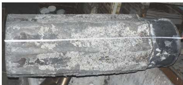
Obr. 5 Odlitý ingot typu V2A Fig. 5 Poured V2A ingot
