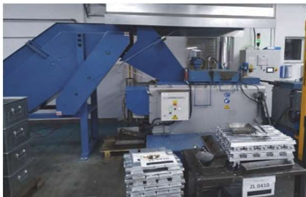
Obr. 1 Předtavnovací pec MELTEC ZTF 700 B s dopravníkem recyklovaného odpadu (vlevo) s předehřátou mobilní pecí MELTEC ZTF 650 (vpravo) [2]
