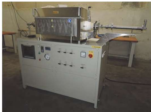
Obr. 2 Laboratorní rotační pec Fig. 2 Laboratory rotary kiln
