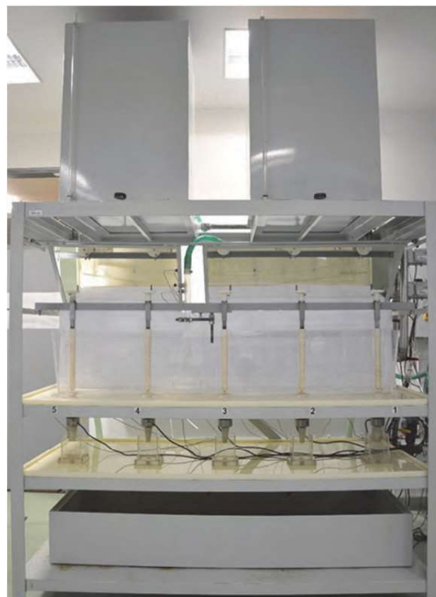
Obr. 1 Sestava fyzikálního modelu pětiproudé mezipánve s příslušenstvím
