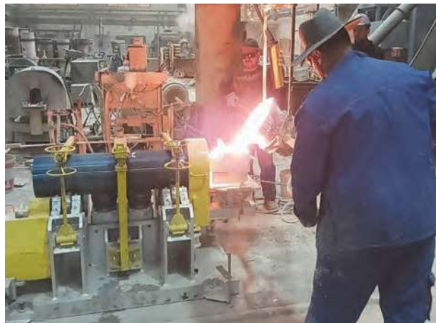
Obr. 1 Lití taveniny do horizontálního lícího stroje HOLS 300
