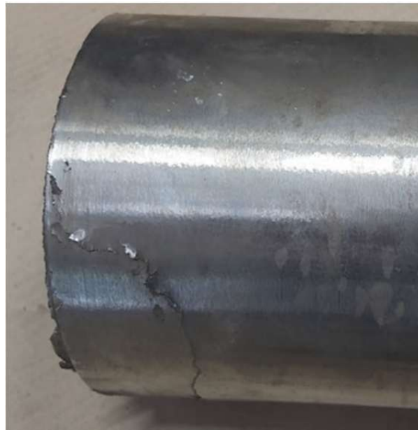
Obr. 4 Přelitá vrstva na konci odlitku
