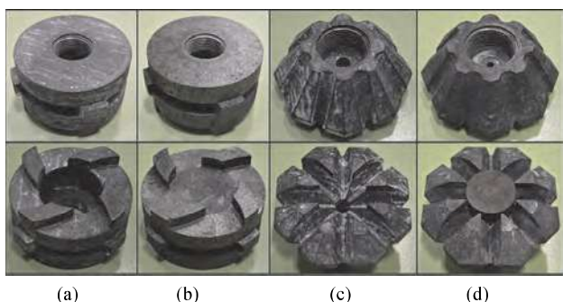
Obr. 4 Rotory použité pro modelování, pohled shora a zespodu: (a) F2A 190; (b) F2A-Z 190; (c) J8 190; (d) J8-ZD 190
