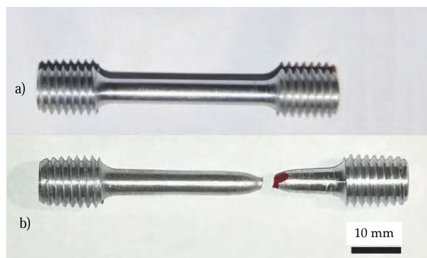
Obr. 6 Vzorky ze slitiny Al-Mn a) před a b) po tahové zkoušce
