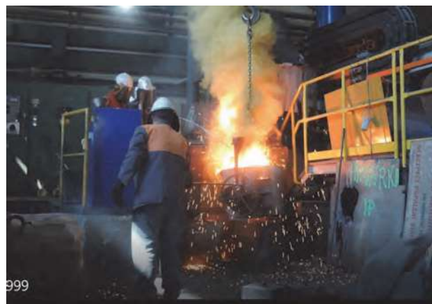
Obr. 3 Legování Bi do proudu taveniny odlévané z atmosférické indukční tavicí pece do lící pánve Fig. 3 Adding Bi into the stream of melt casted from the the induction melting furnace
