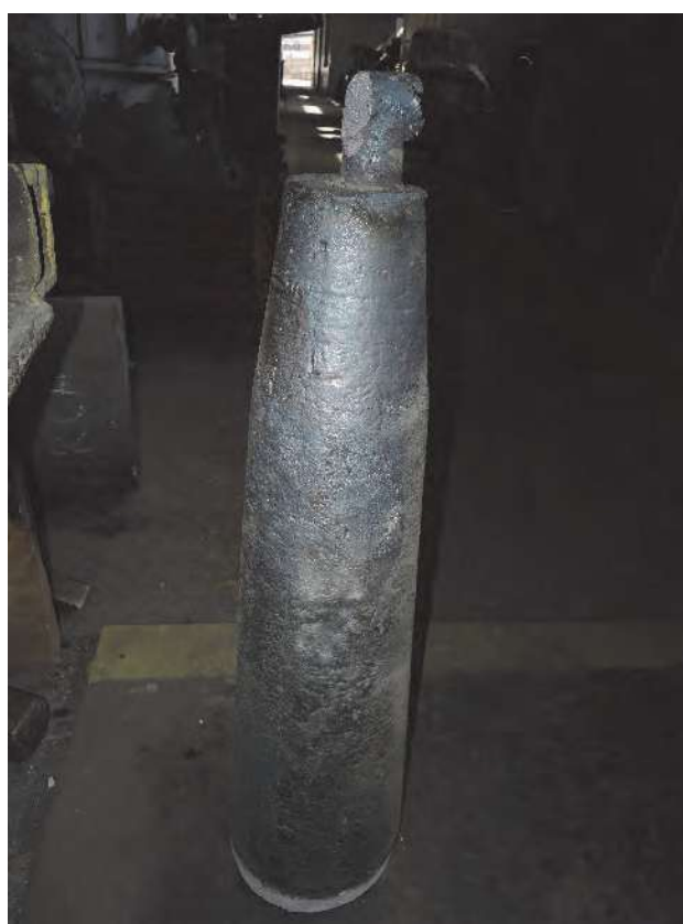
Obr. 5 Odlitý ingot z oceli s 0,12 % Bi Fig. 5 Ingot cast from steel with 0.12 % Bi
