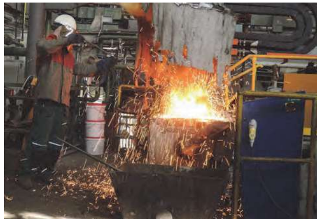
Obr. 2 Legování Bi přímo do kelímku indukční tavicí pece Fig. 2 Adding Bi directly into the crucible of the induction melting furnace
