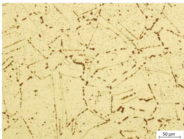
Obr. 14 Mikrostruktura oceli HR3C se \sigma -fází vyloučenou na hranicích zrn po vysokoteplotní expozici v kotli po dobu jednoho roku při teplotě 750 °C Fig. 14 Microstructure of HR3C steel with \sigma -phase at grain boundaries after high temperature exposure at 750°C in a boiler for one year
