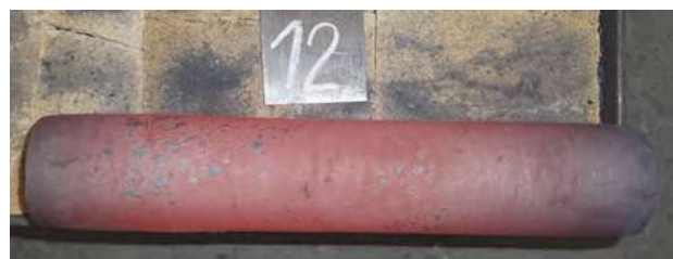
Obr. 9 Vzorek vyděrovaný s největším rozšířením cca 14 % a nejmenší deformací; nastavení úhlů \alpha = 4 , \beta = -2 , úběr 3,5 mm (malý), deformace okolo 36 %, průměrné rozšíření 13 %
