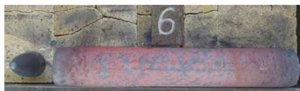
Obr. 8 Vzorek po ideálně povedeném děrování s nepoškozeným děrovacím trnem; nastavení úhlů \alpha = 4 , \beta = -1,5 , úběr 5,5 mm, deformace 45 %, průměrné rozšíření 9 %
