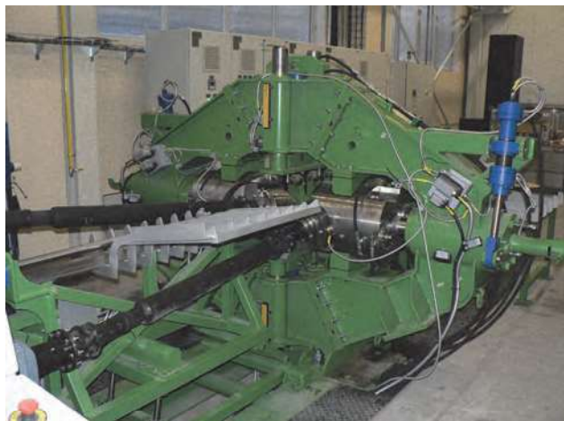
Obr. 1 Univerzální laboratorní děrovací stolice Fig. 1 Universal laboratory piercing mill
