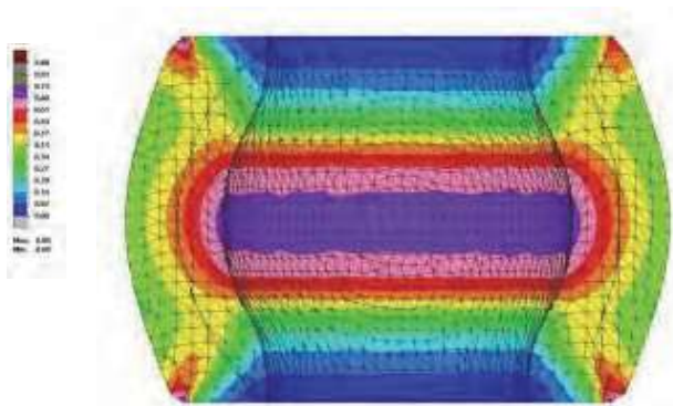
Obr. 13 Rozložení deformací při pěchování dutého ingotu – tenčí stěna dutého ingotu
