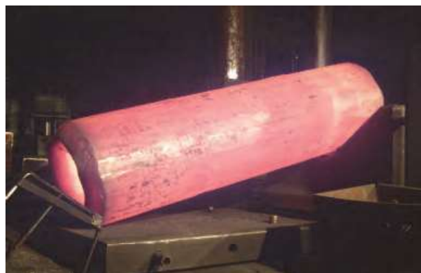
Obr. 21 Výkovek z dutého ingotu Fig. 21 The forging made from hollow ingot
