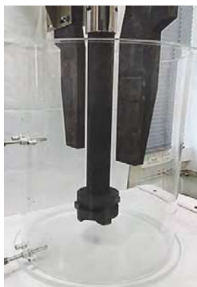
Obr. 1 Fyzikální model zařízení pro rafinaci hliníku [11]
